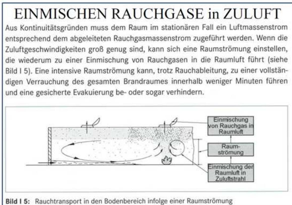
Abb. 5.2.3: **Strömungsbild Rauchtransport** in den Bodenbereich durch Raumströmung
